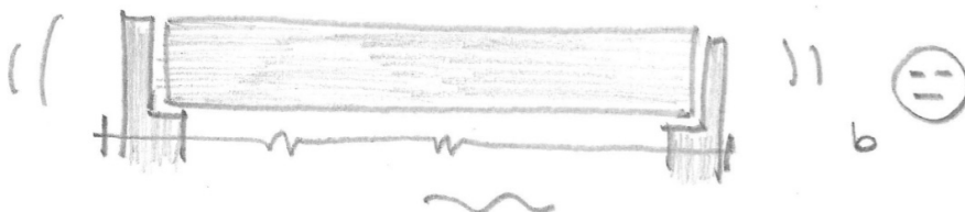
Figura 4.5 - Collegamento indiretto fra trave e colonne ottenuto con inserimento di tirante tra le colonne
