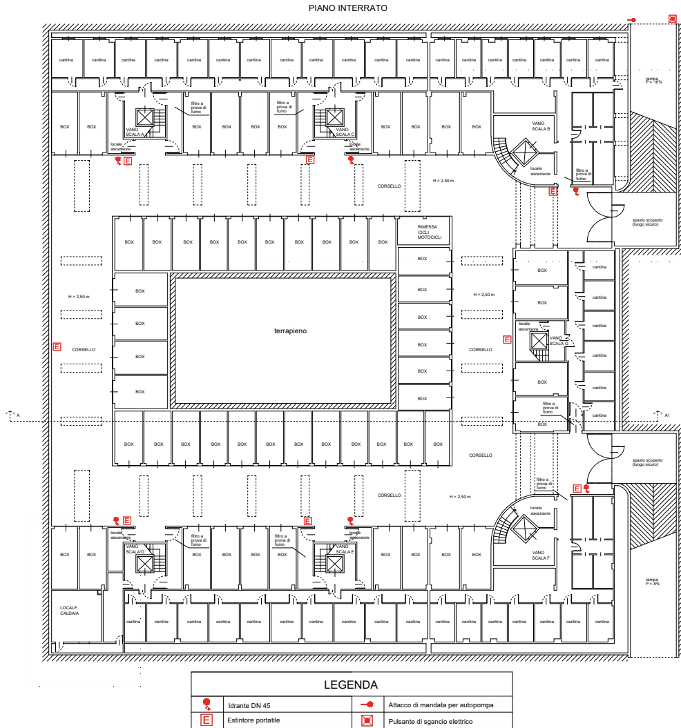
Figura 12.1 - Planimetria generale dell'autorimessa
